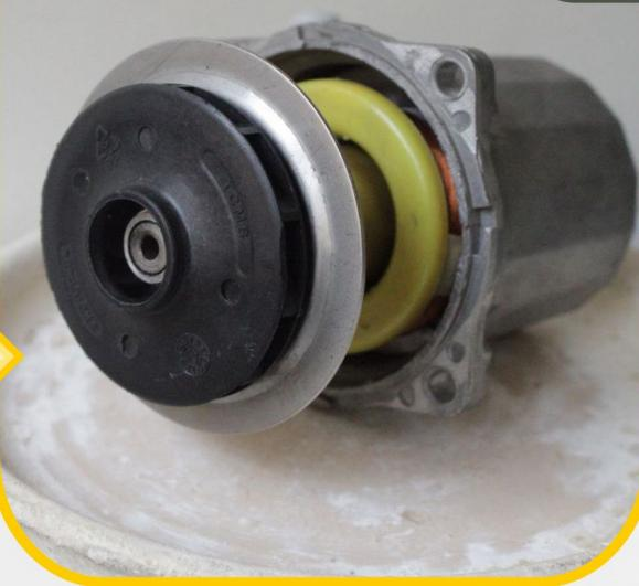
پمپ های آب خنک یا WET PUMP از اجزا بسیار پر کاربرد و موم در هر سیکل بسته هستند که معمولاً سریعتر از بقیه اجزا در معرض آسیب های ناشی از رسوب ذرات مگنتایت یا رسوب فلزی قرار می گیرند.
